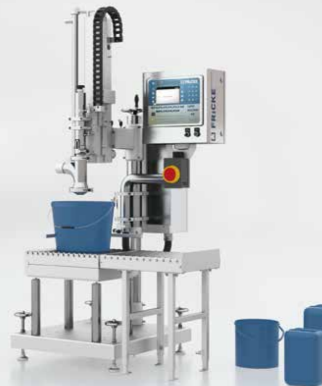
EFS 51 Положение дозатора выше уровня жидкости
