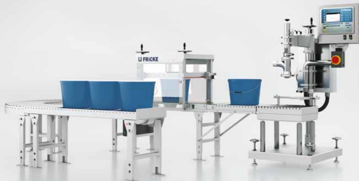
EFS 11 с системой установки крышек DS 400
